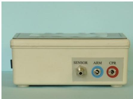
1. Conecte el tubo de látex conectado al esfigmomanómetro con la unidad de control en el terminal marcado como "SENSOR".
