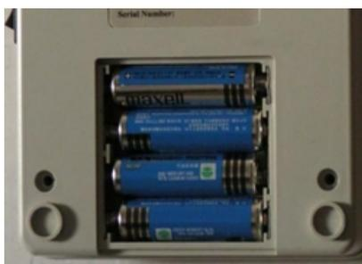
Después de haber instalado 4 pilas "AA" según la indicación grabada en la parte inferior del casete. El usuario puede finalizar el proceso restaurando la tapa móvil del casete de la batería. Se recomienda utilizar pilas alcalinas para prolongar su tiempo de trabajo. Un icono de batería en la esquina superior izquierda de la pantalla LCD indica si las baterías carecen de energía.
